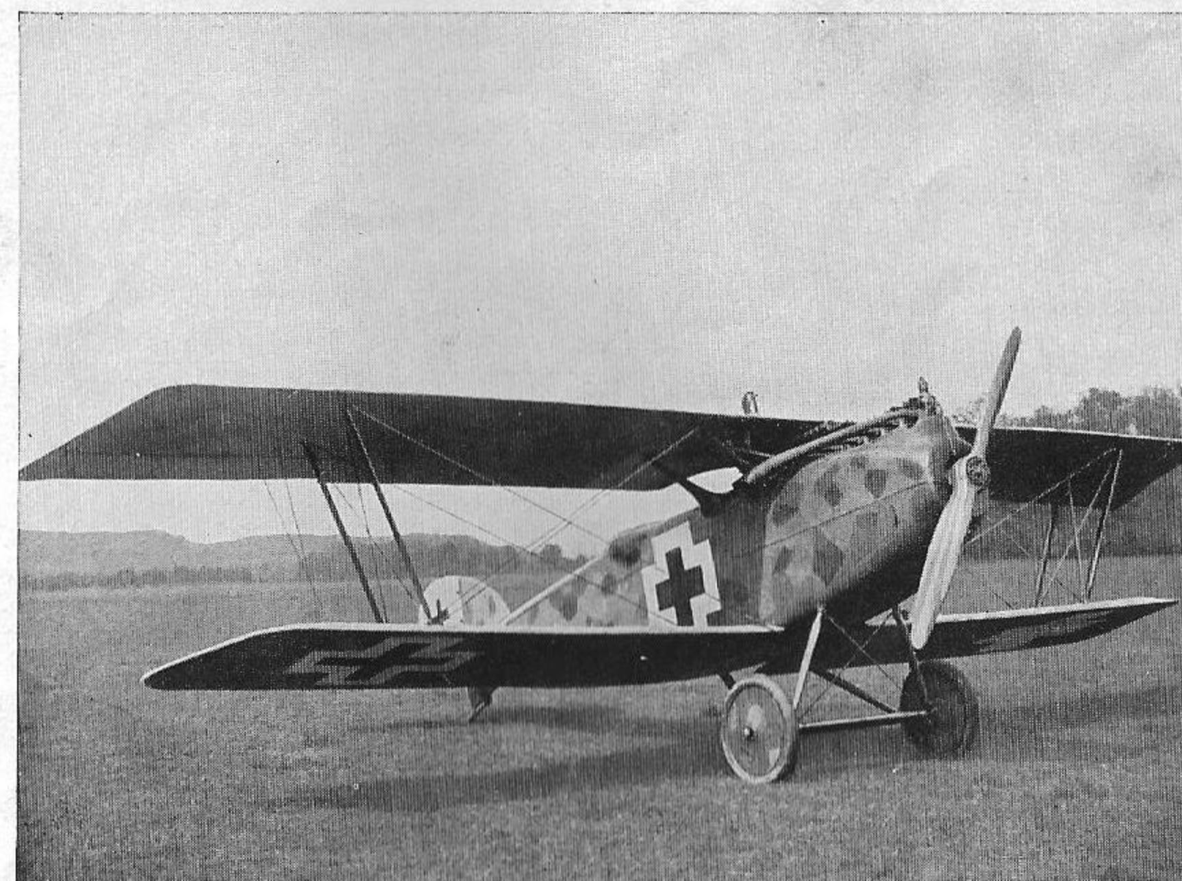
Afb. 6. Dornier C1 Verkenner in metaaluitvoering met 160 PK Mercedes-motor. Bouwjaar 1918.
