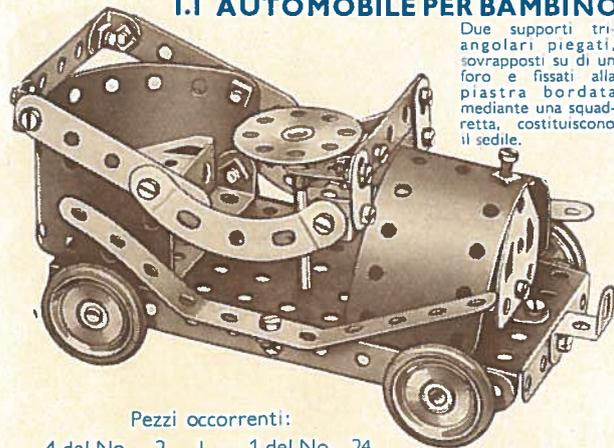
Due supporti triangolari piegati, sovrapposti su di un foro e fissati alla piastra bordata mediante una squadretta, costituiscono il sedile.
