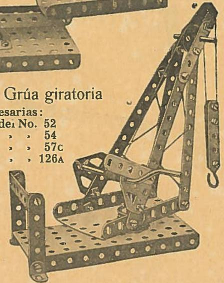
La Placa de Sector de la grúa en este modelo está colocada sobre un pivote en fondo y hay una Polea fija encima y debajo.
