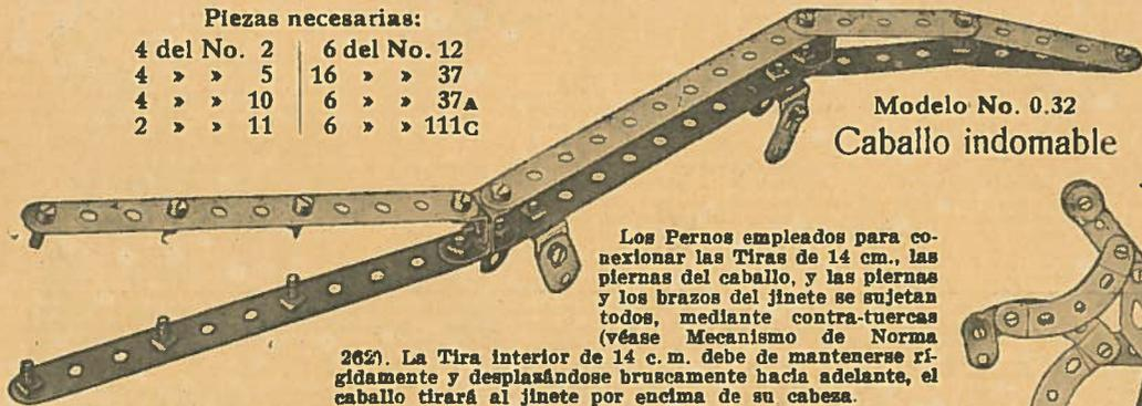
Los Pernos empleados para conectar las Tiras de 14 cm., las piernas del caballo, y las piernas y los brazos del jinete se sujetan todos, mediante contra-tuercas (véase Mecanismo de Norma 262). La Tira interior de 14 c. m. debe de mantenerse rigidamente y desplazándose bruscamente hacia adelante, el caballo tirará al jinete por encima de su cabeza.
