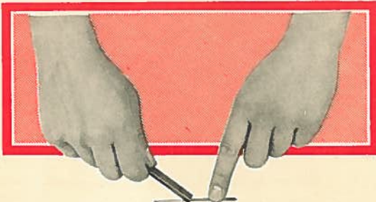
Fig. 8. Aimantation d'une aiguille au moyen d'un Barreau Aimanté.
