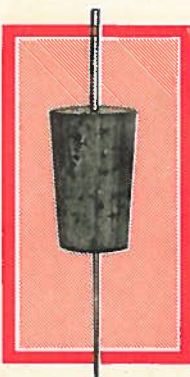
Fig. 22. Aiguille aimantée et bouchon employés pendant les expériences avec l'aimant flottant.
