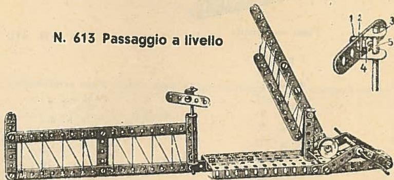
Il fissaggio del segnale, striscia N. 5, avviene mediante la vite (1) N. 37a con dado (2) N. 37c; indi si applica sul supporto doppio (3) N. 11 bloccato con altro dado (4) N. 37c. Il tutto va poi applicato all'albero (5) N. 15a trattenuto da due fermagli a molla N. 35. Il movimento della sbarra si ottiene fissando il capo della fune al foro della striscia vicino alla puleggia N. 22 passando sotto l'albero posto fra due staffe N. 60/7 e arrotolato sulla manovella N. 19.
