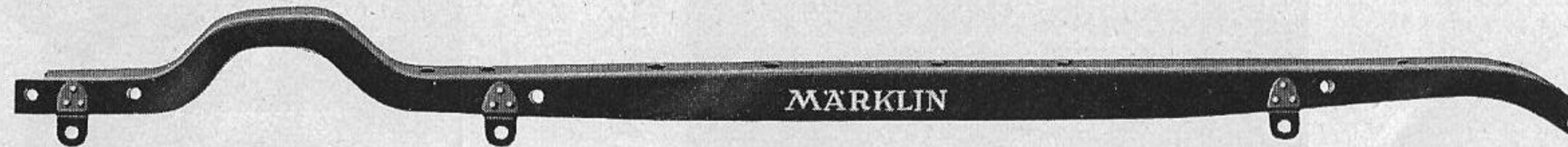
C 2 Rechter Längsträger
