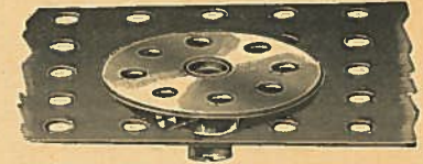
D - Schraube als Stützzapfen.
