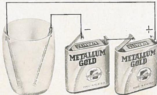
Der frisch aufgeladene Akkumulator besitzt eine Klemmenspannung von 2,1 Volt je Zelle. Diese sinkt zu Beginn der Entladung rasch auf zirka 1,9 Volt, bleibt dann längere Zeit annähernd gleich und sinkt dann schnell weiter. Bei 1,8 Volt soll die Ladung unterbrochen werden, da der Akkumulator sonst Schaden leidet.
