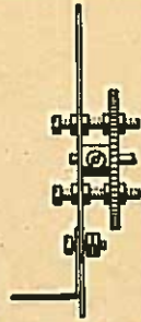
Abb. 70/1b Befestigung des Zahnrades Nr. 1032a an der Exzentrerscheibe - Drehscheibe Nr. 1077
