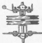
No. 74a Schnitt durch die Drehachsenlagerung - Sezione del cuscinetto dell'asse rotante - Section transversale du coussinet de l'axe giratoire - Tvärsnitt av vridaxellagringen.
